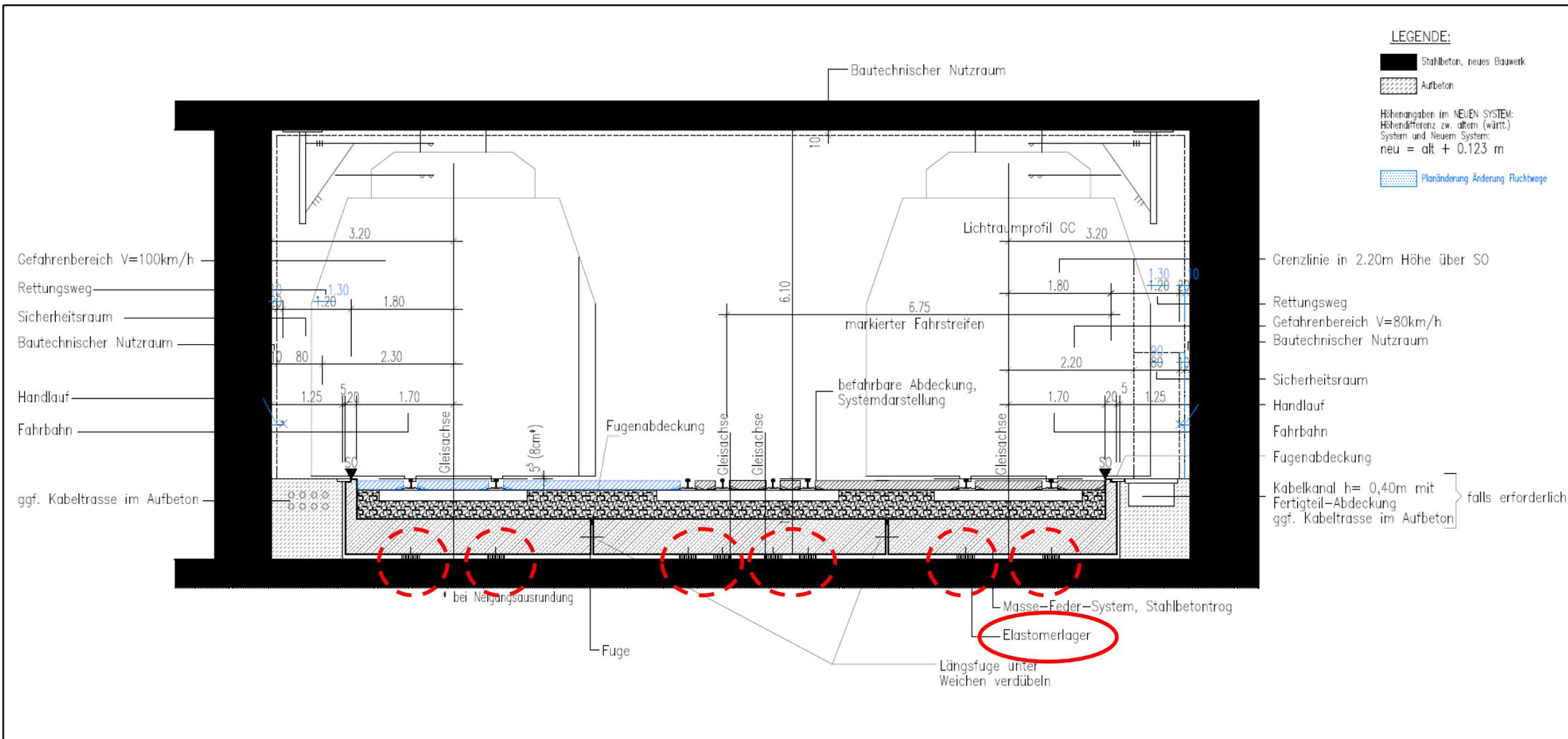
**Aus 18. Planänderungsantrag: ANLAGE 10.2.3: SCHNITT TUNNEL mit Masse-Feder-System [letzte Änderung: 29.2.2016]**
