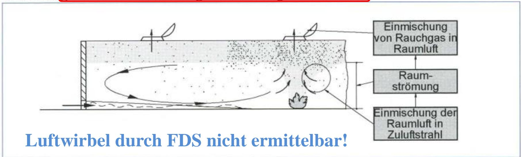
**Bild I 5:** Rauchtransport in den Bodenbereich infolge einer Raumströmung
