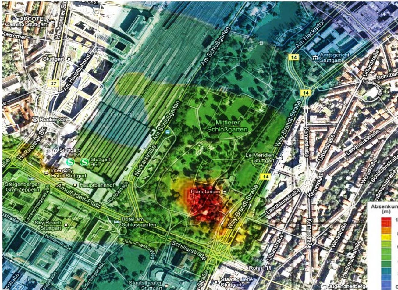
Grundwasserabsenkung mit Infiltration: Reichweite erheblich verringert.
